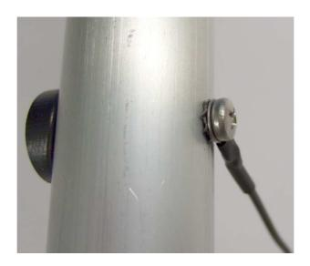
Die Litze zum entsprechenden Elementhalter auf dem Spreizer oben links führen und befestigen, und von dort im Uhrzeigersinn (Pfeil) auf allen weiteren Spreizern befestigen.
