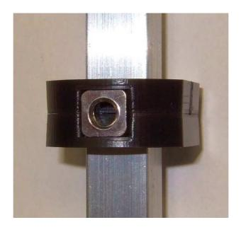
☐ Jetzt den Vierkantstab in das Tragrohr stecken, mit dem abgerundeten Ende nach oben (Richtung Einspeisepunkt). Den Stab so ausrichten, dass die Vierkantmuttern hinter den kleinen Bohrungen, und die Durchgangslöcher der Zentrierteile mittig hinter den großen Bohrungen sichtbar werden.
