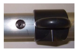
Auf alle 6 großen Bohrungen Isolierbuchsen stecken und mit M4 x 20 Schrauben lose verschrauben. Die Bohrung der Isolierbuchsen vorher ggf. mit einem 4 mm Bohrer aufweiten. In alle 6 kleinen Bohrungen M4 x 8 Schrauben lose eindrehen. Der Vierkantstab ist jetzt im Tragrohr fixiert.
