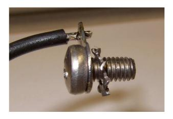
Die Litze mit der Lötöse voran von aussen durch das Mitteloch vom Einspeisepunkt stecken und die M4 Schraube lose in das Gewinde an der Stirnseite des Vierkantstabs eindrehen. Die Zahnscheibe muß zwischen Lötöse und Vierkantstab sitzen.
